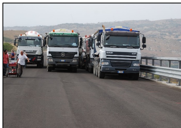
Figura 3 Configurazione di carico su tre corsie
