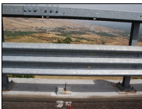
Figura 7 Posizionamento inclinometri biassiali
