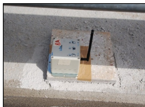
Figura 7 Posizionamento inclinometri biassiali
