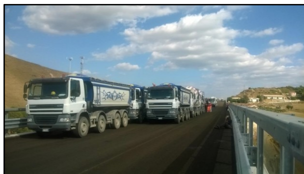
Figura 2 Configurazione di carico su due corsie
