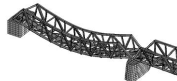
Fig. 18. Seconda forma modale FEM Campata 1 – Flessionale f_2 = 6.07 Hz
