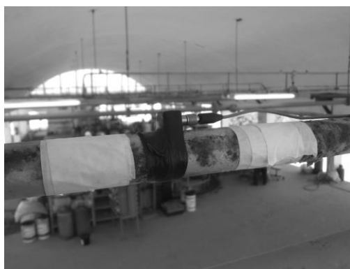
Fig. 6 Posizionamento dell'accelerometro sulla catena
