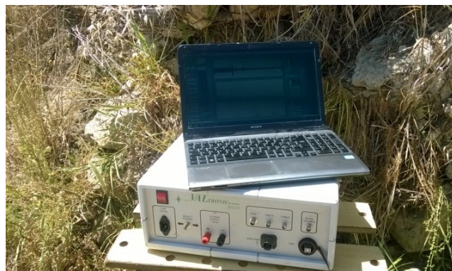
Figura 5. Centralina con convertitore A/D HW e SW di acquisizione
