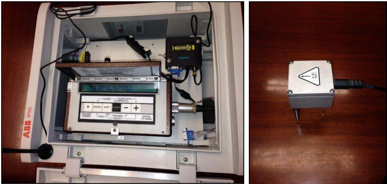
Figura 9: Centralina di monitoraggio dinamico di trasmissione dati (sx) e velocimetro triassiale (dx).
