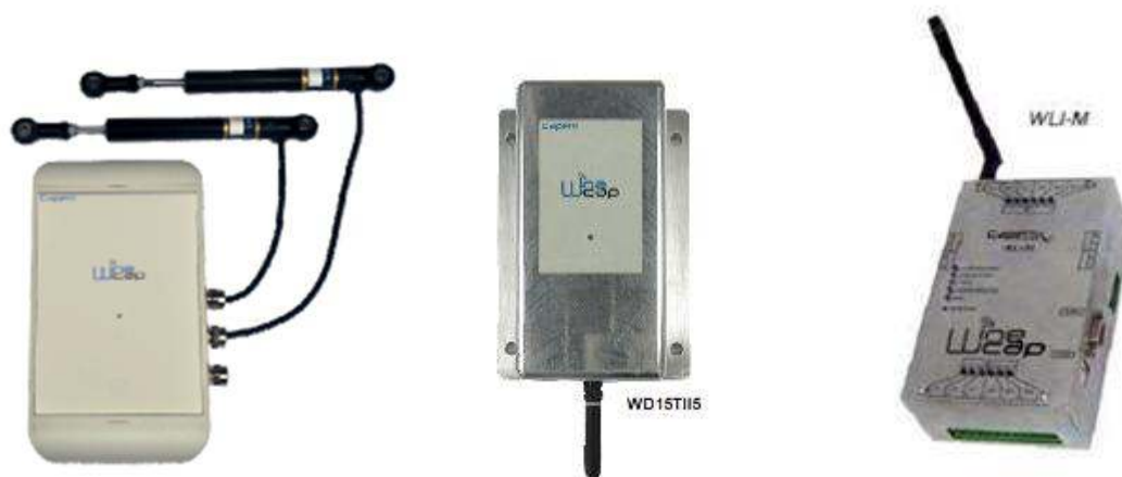
Figura 4: Sistemi di acquisizione dati; a) Centralina di acquisizione degli spostamenti, b) Centralina di acquisizione delle inclinazioni, c) Centralina di raccolta e trasmissione dei dati.
