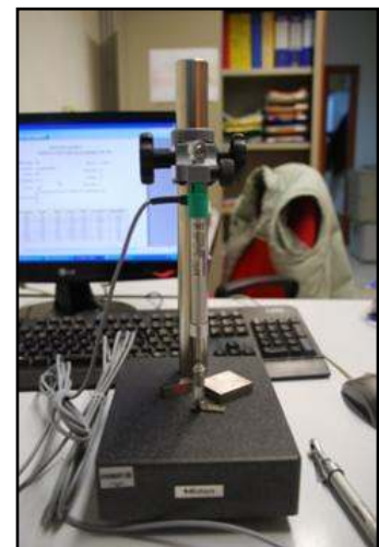
Figura 6 - Taratura dei trasduttori di spostamento
