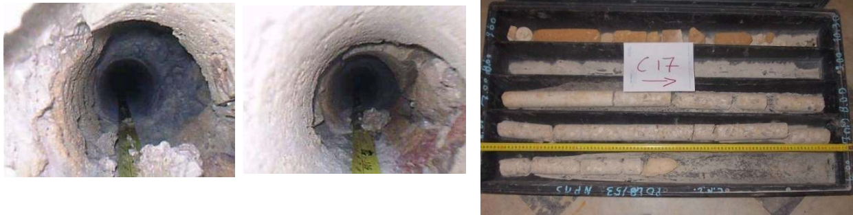
Carotaggio, Endoscopia in foro – foto 15, 16, 17
