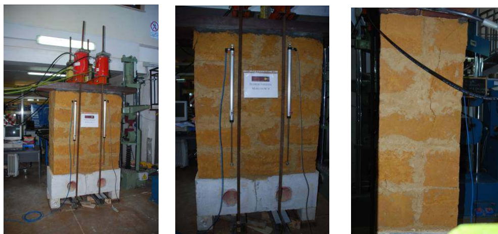
Prova di compressione su muretto – foto 9, 10, 11
